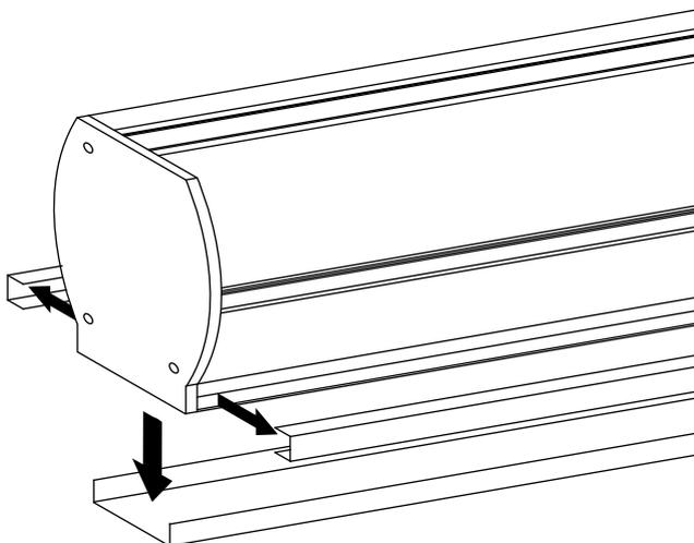
**2.** Emboîtez les gouttières avec la plaque 40x4 (Vis 4,8x19) et les petites plaques (Vis 4,2x13).
