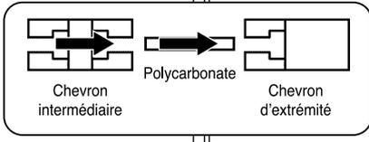
6. Visser les deux profils plats sur les chevrons afin de garantir l'écartement entre les chevrons ceintrés (Vis 4,8x19, Bouchon 1)
