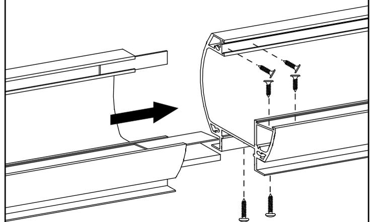
3. Visser la gouttière aux piliers et silconer les vis et leur pourtour (Vis 4,8x13).
