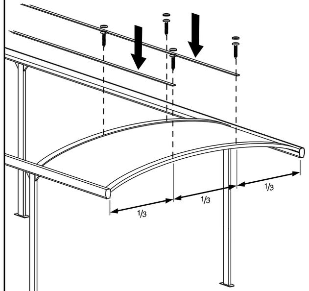
7. Répéter les points 5. et 6., jusqu'au dernier chevron (Écrou, Vis 4,8x19, Bouchon 1).
