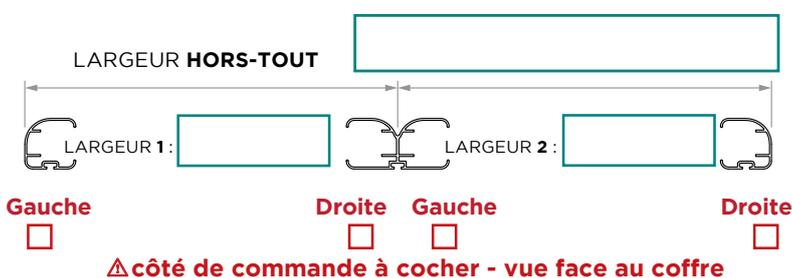
**⚠** Dans le cas d'une manœuvre motorisée radio, il est déconseillé de positionner les moteurs l'un à côté de l'autre sous risque d'interférence.
