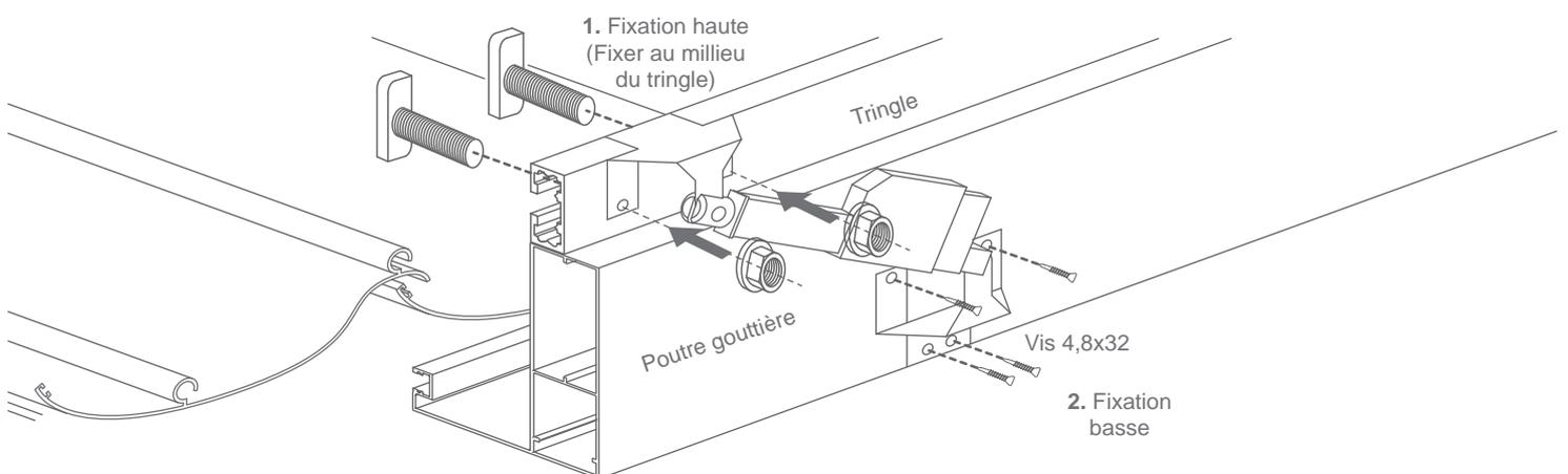
**ATTENTION:** Au sens des lames par rapport au moteur et fixer le support moteur supérieur au milieu de la pergola.
